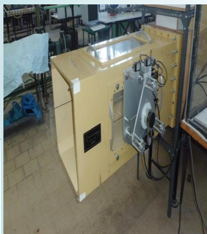
Γεωμετρία διάταξης μέσω CAD Θέση αεροδυναμικού ζυγού στη διάταξη
