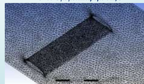
Υβριδικό 3D πλέγμα της αεροτομής NACA0015 με μεταπτερύγιο στις 5°
