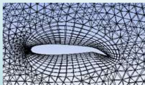
Υβριδικό 3D πλέγμα της αεροτομής NACA0015 με μεταπτερύγιο στις 25°
