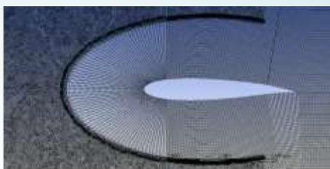
Υβριδικό 2D πλέγμα της αεροτομής NACA0015 με μεταπτερύγιο στις 5°
