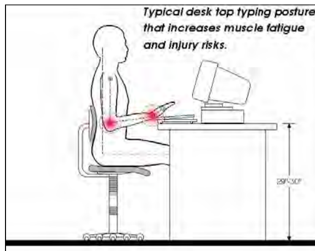
Εικόνα 6.11 Λάθος στάση πληκτρολόγησης
