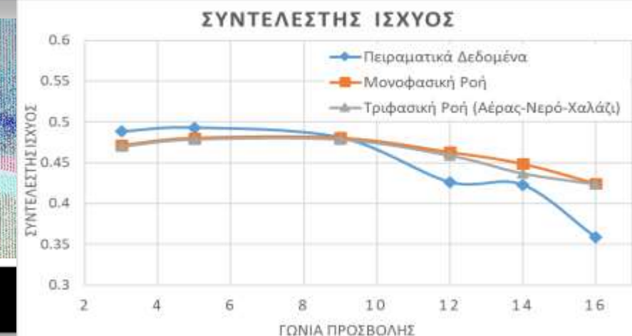
Συντελεστής ισχύος μονοφασικής και τριφασικής ροής, συναρτήσει της γωνίας προσβολής για αριθμό Reynolds Re = 1.5 \times 10^6
