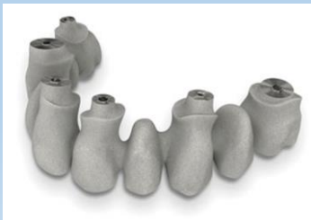
Οδοντικά εμφυτεύματα κατασκευασμένα με SLS
