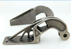
Αεροναυπηγικά εξαρτήματα κατασκευασμένα με συμβατικές μεθόδους κατεργασίας (πίσω) και με AM (μπροστά).
