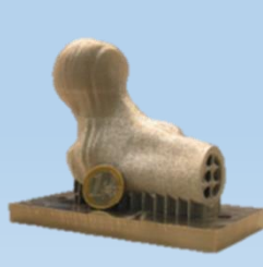
Τεχνητό οστό κατασκευασμένο από κυψελοειδή δομή με SLM
