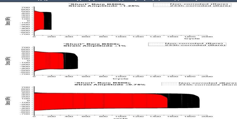
Σχήμα 4. Διάγραμμά τάσεων-κύκλων φόρτισης για γυμνά μη-διαβρωμένα και διαβρωμένα γυμνά δοκίμια
