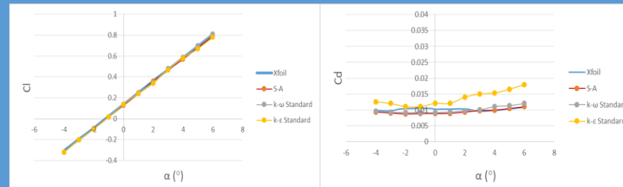
C_L και C_D συναρτήσει γωνίας προσβολής αεροτομής ρίζας
